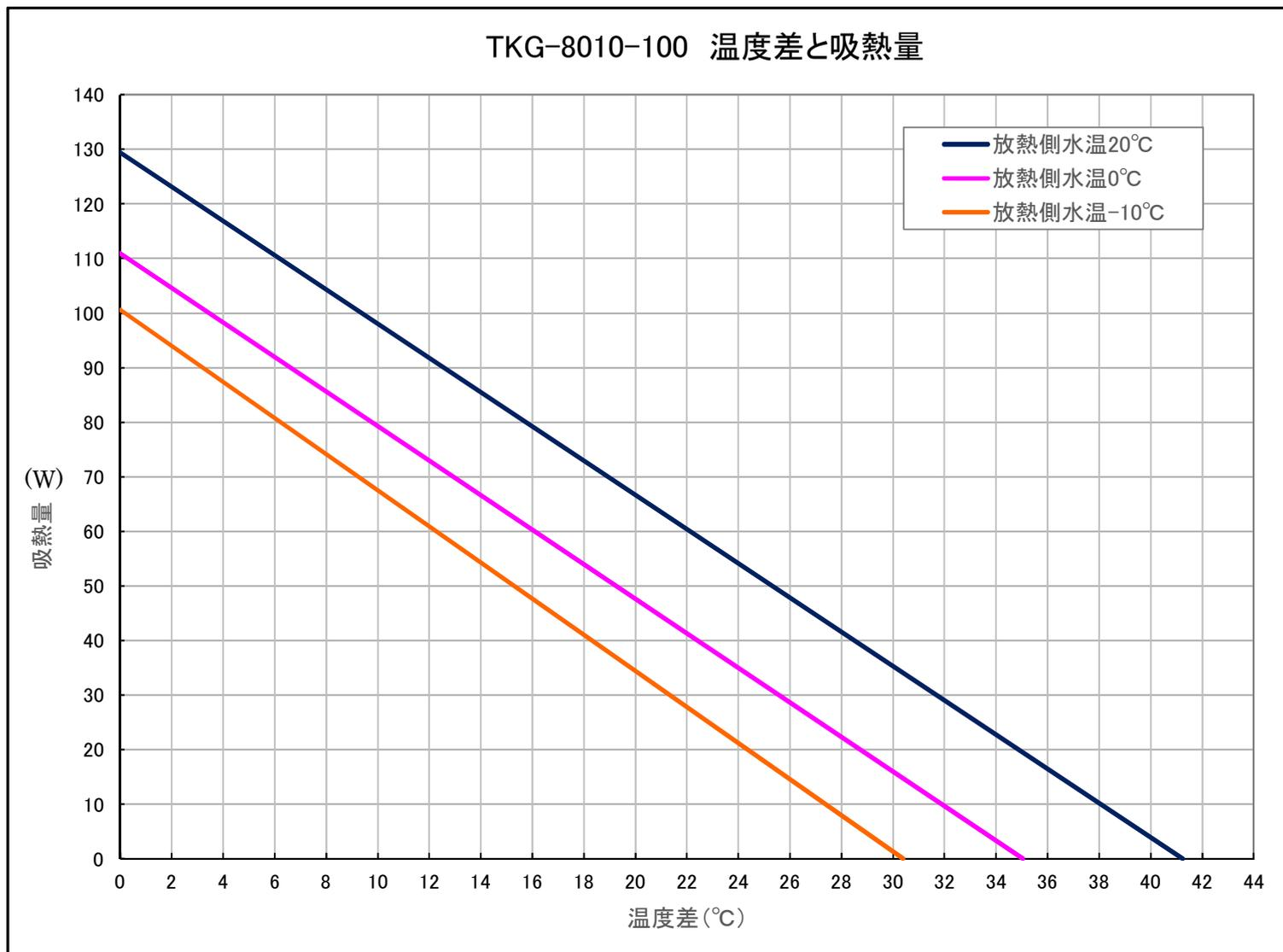
※温度差 = 放熱側水温 - 冷却板温度
